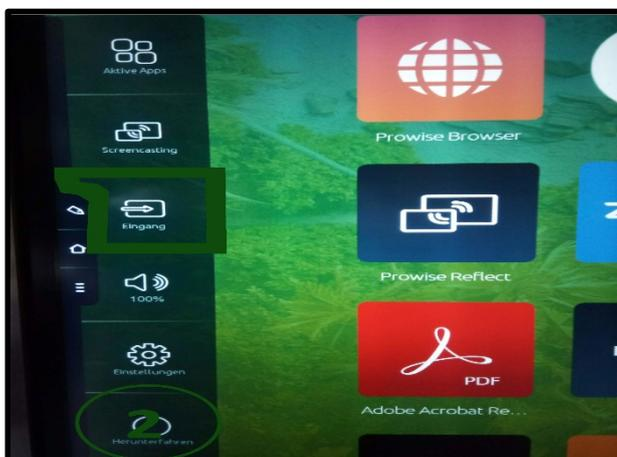
2 – Die vertikale Bedienungsleiste aufklappen. Bei diesem Schritt kann man die Zuschaltung über HDMI-/VGA-/Analoganschlüsse bedienen. Zugleich kann man hier auch Zugriff auf das PC.
